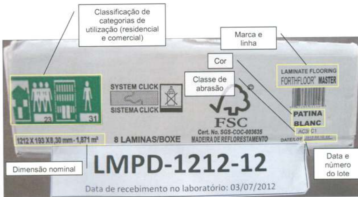
Foto 2 – Informações impressas na embalagem da amostra recebida: códigos do sistema de classificação para categorias de utilização, dimensão nominal, marca, linha, cor ou padrão, classe de abrasão, data e número do lote.
