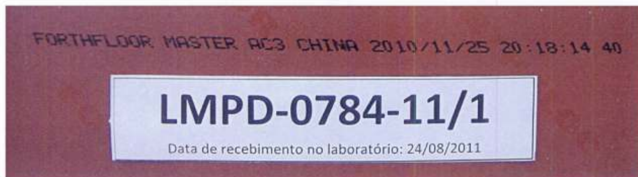
Foto 4 – Informações impressas no verso de uma placa retirada da amostra: marca comercial, linha, classe de abrasão, país de origem, data (ano/mês/dia), hora de fabricação e número de lote.
