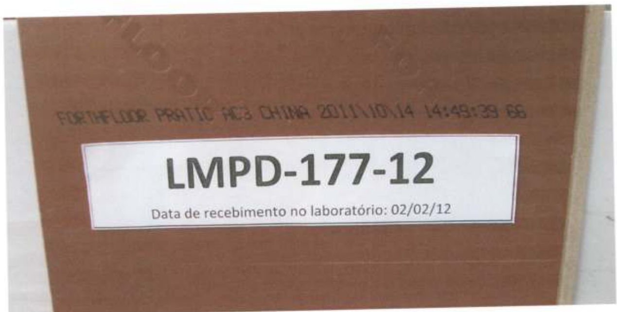
Foto 3 – Informações impressas no verso de uma placa retirada da amostra: marca comercial, linha, classe de abrasão, país de origem, data (ano/mês/dia), hora de fabricação e número de lote.
