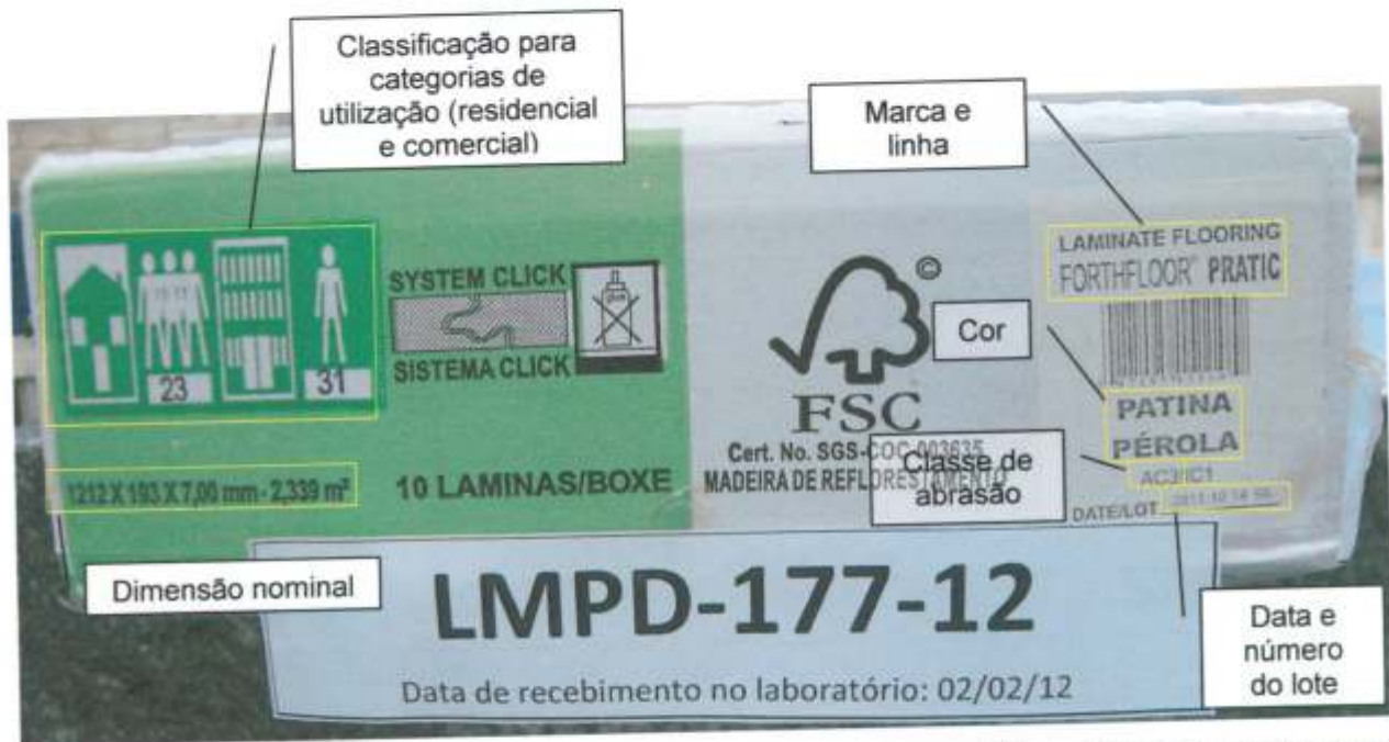
Foto 2 – Informações impressas na embalagem da amostra recebida: códigos do sistema de classificação para categorias de utilização, dimensão nominal, marca, linha, cor ou padrão, classe de abrasão, data e número do lote.
